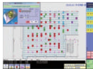
多機群控顯示，點擊圖示單元可顯示單機運轉資料。 Group control mode
